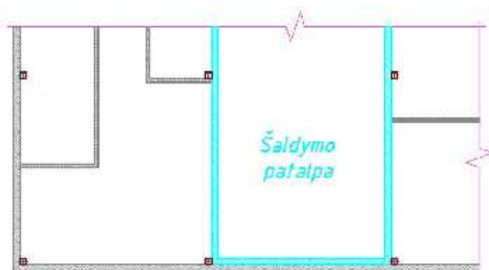
16P.11 pav. Daugiasluoksnis plokščiasis sienų žymėjimas brėžiniuose
