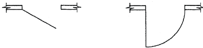
16P.14 pav. Šoniniais vyriais tvirtinamų durų žymėjimas mažo mastelio plano brėžiniuose
